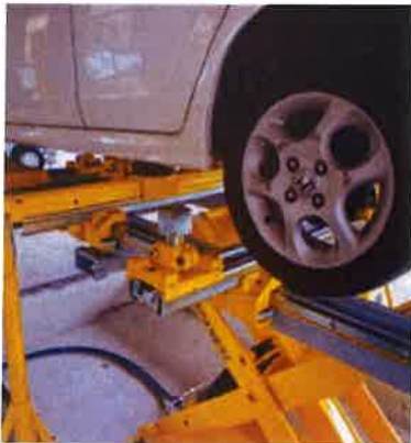
(左上) セリエ100インフロアジグ修正機 (右上) リフトアップ作業 (左下) ジグセット作業 (右下) フレーム修正作業
